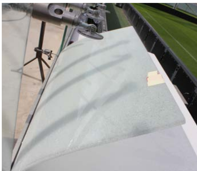
4. Resistenza residua post-rottura.
