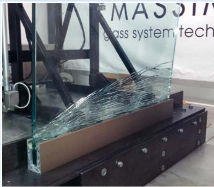
Foto di rottura di una lastra in 10+10+1,52mm PVB, vetri non temprati. Ancoraggio continuo alla base con sistema DEFENDER. Altezza dal piano di calpestio H=1100\text{mm} e larghezza L=1000\text{mm} . Carico di rottura pari a 1.60\text{ kN/m} . Test effettuato secondo alcuni dettami ripresi dalla UNI 10806
